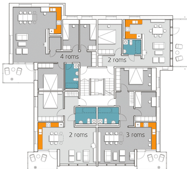
Fig. 151: Planløsning som viser sentralt trapperom i blokk
